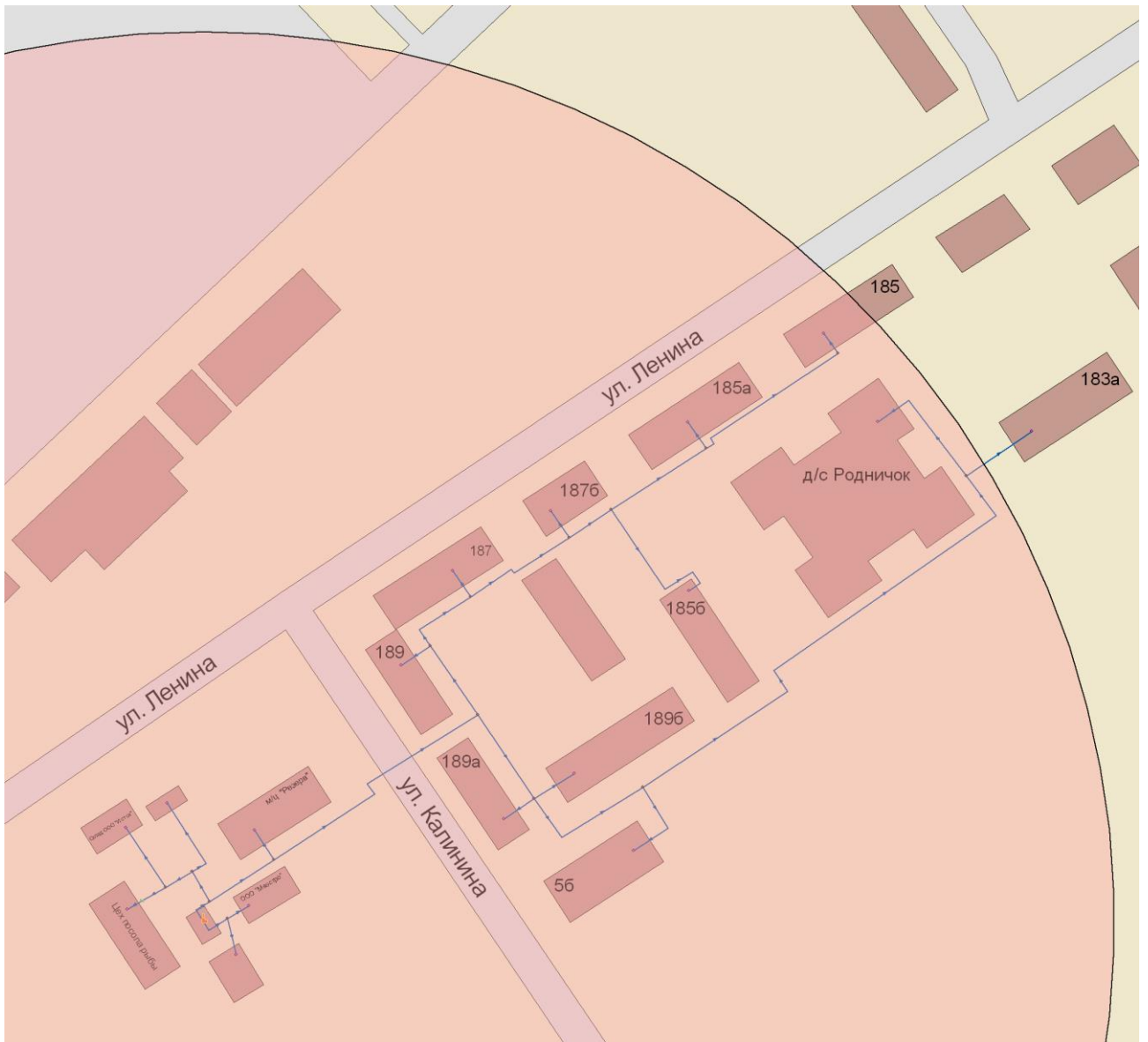
Рисунок 72. Радиус эффективного теплоснабжения от здания котельной ул.Ленина, 1766/1 (Водник)
