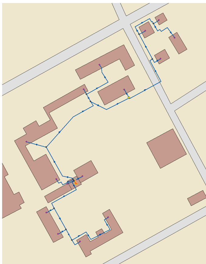
Рисунок 19. Схема тепловых сетей от котельной ул. Гоголя, дом №29/1 (Педагогический колледж)
