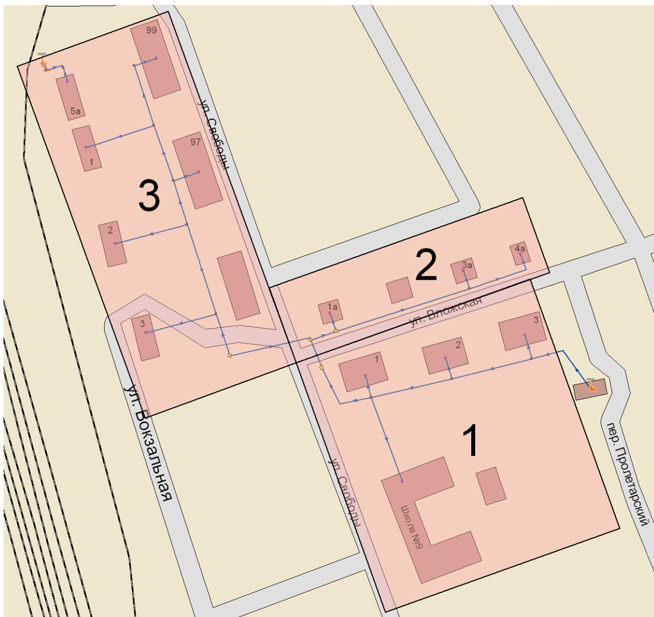
Рисунок 65. Зона действия здание котельной ул. Волжская, дом №4 (расчетная схема)
