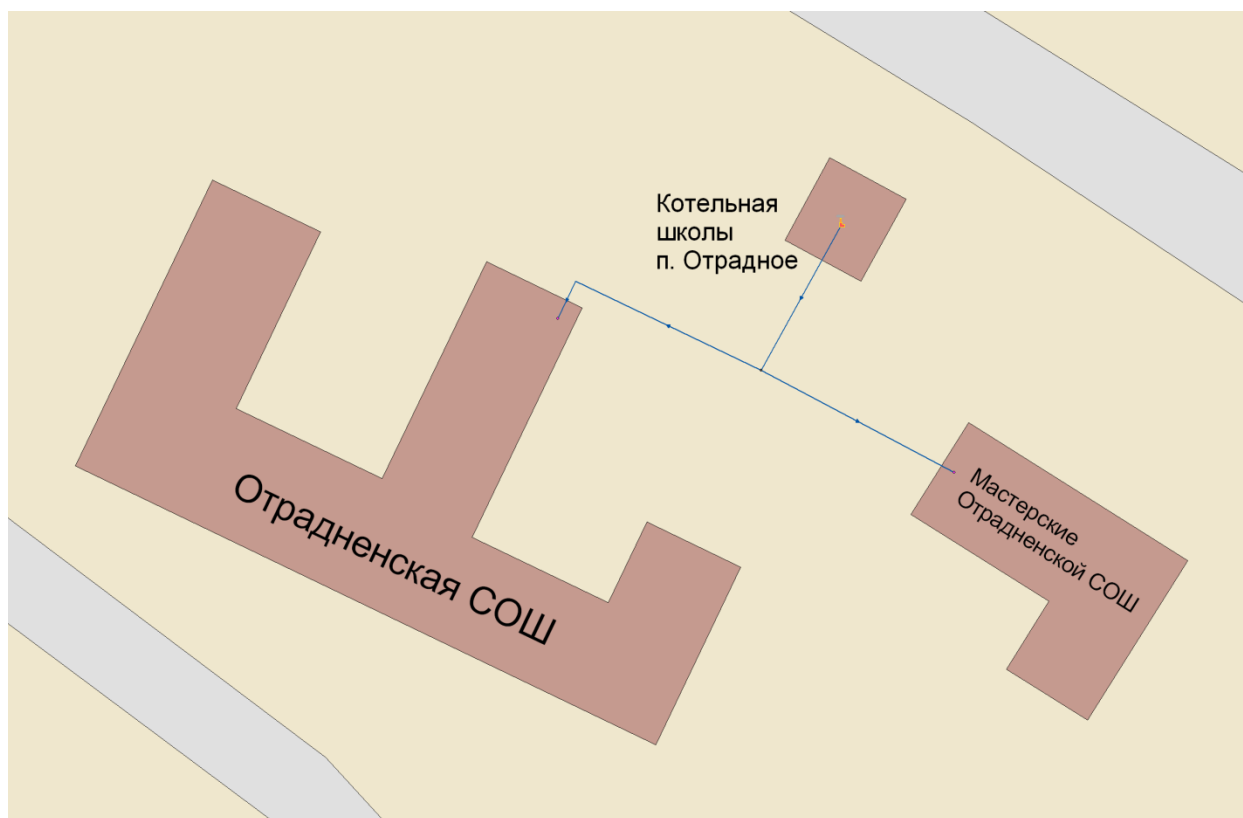
Рисунок 32. Схема тепловых сетей от котельной школы п. Отрадное
