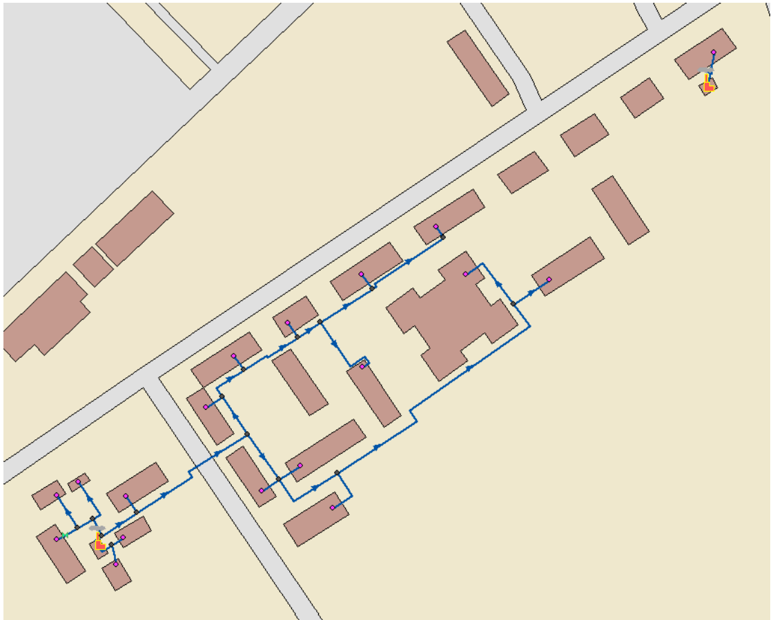
Рисунок 10. Схема тепловых сетей от здания котельной ул. Ленина, 1766/1 (Водник) и мини-котельной ул. Ленина, дом №1776
